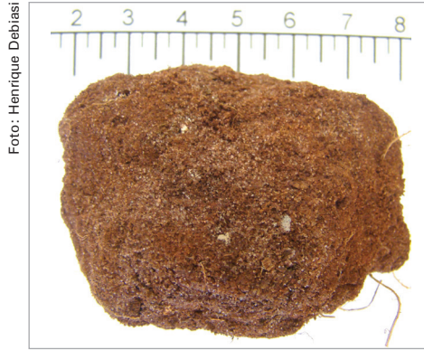
Figura 11. Presença de areia iluviada sobre as superfícies de ruptura do agregado. Escala em centímetros (cm).
