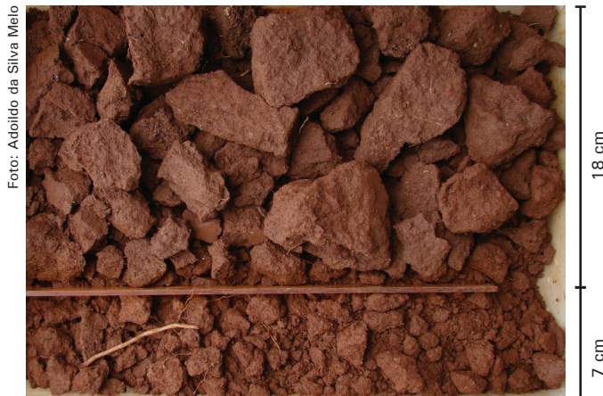
Figura 24. Exemplo de amostra com duas camadas, uma com 18 cm de espessura e Qe_c = 2 , e outra com 7 cm de espessura e Qe_c = 3 , gerando um IQEA = 2,28.
